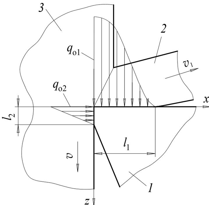
В процессе резания существуют два источника тепловыделения от трения: между передней поверхностью инструмента  $1$  и стружкой  $2$ , а также между задней поверхностью инструмента и заготовкой  $3$ .
