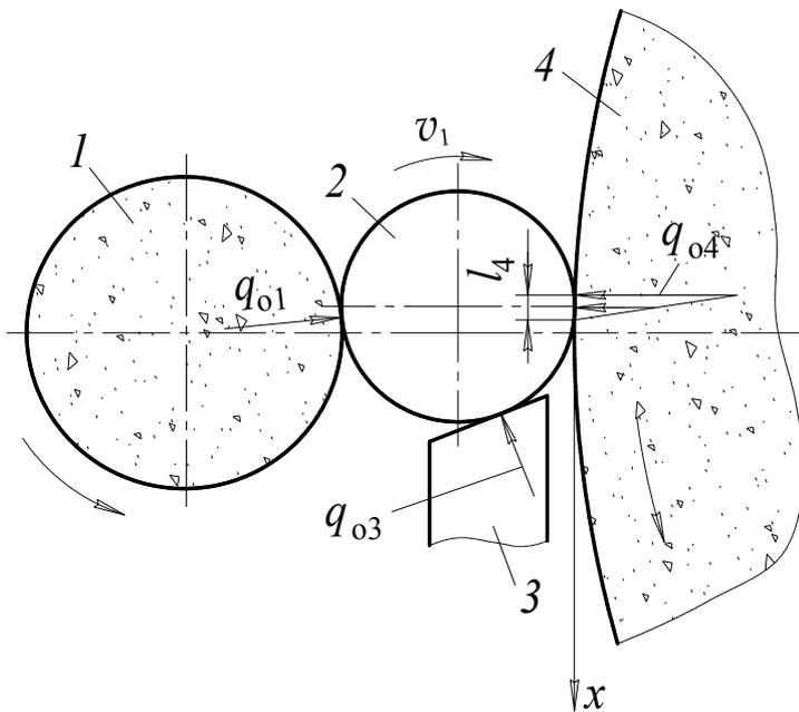
При врезном бесцентровом шлифовании заготовки из стали ХГН ( $\omega = 0,07 \cdot 10^{-4} \text{ м}^2/\text{с}$ ) из всей мощности 5 кВт установленного на станке электродвигателя 11,8% теряется из-за трения в механизмах станка, а еще 1,5% расходуется на преодоление трения между заготовкой 2 и опорным ножом 3.
