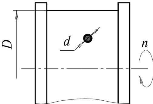
Для повышения твердости и износостойкости поверхности беговую дорожку внутреннего кольца роликового подшипника обрабатывают лазером. Заготовка вращается с частотой  $n = 30$  об/мин. Лазерный луч создает на поверхности диаметром  $D = 60$  мм пятно нагрева диаметром  $d = 1$  мм.
