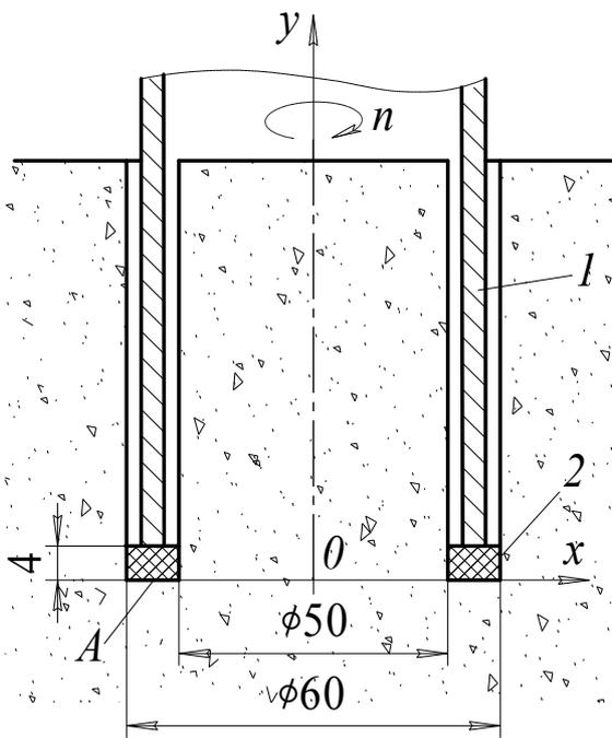
Для изготовления отверстий в бетоне применяют алмазное сверло, представляющие собой металлическую трубку 1, к торцу которой припаяно алмазосодержащее кольцо 2. Основное тепловыделение при работе сверла происходит на торце *A*.
