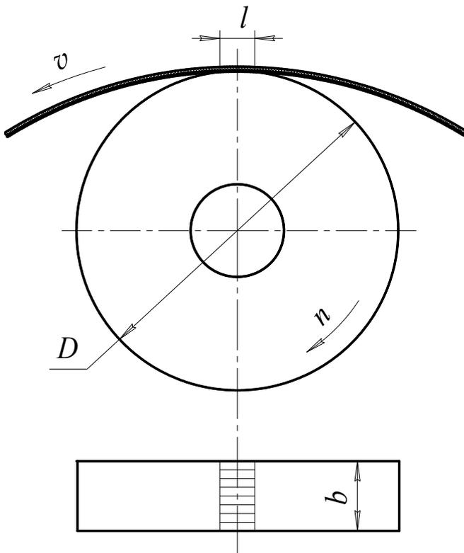
Ролик диаметром  $D = 100$  мм и толщиной  $b = 20$  мм из коррозионно-стойкой стали ( $\lambda = 23$  Вт/(м·°С),  $\omega = 0,05 \cdot 10^{-4}$  м<sup>2</sup>/с) полируют эластичной лентой, движущейся с некоторой скоростью  $v$ . Ролик вращается с частотой  $n = 40$  об/мин. Длина площадки контакта между роликом и лентой  $l = 5$  мм.
