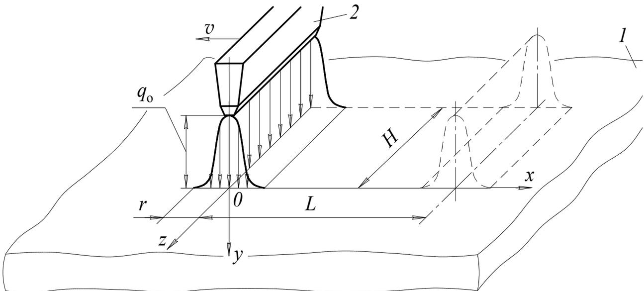
Горелка перемещается со скоростью  $v = 0,6$  м/мин. За время, пока горелка прошла расстояние  $L = 120$  мм, она выделила 3500 Дж теплоты, причем 90% этой теплоты ушло на нагревание листа, а остальная – на лучистый теплообмен пламени с окружающей средой.
