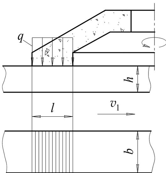
Прямоугольный источник теплоты шириной  $l = 10$  мм перемещается со скоростью  $v_1 = 3$  м/мин по поверхности пластины из стали ШХ15, имеющей теплопроводность  $\lambda = 33$  Вт/(м·°С) и температуропроводность  $\omega = 0,065 \cdot 10^{-4}$  м<sup>2</sup>/с.
